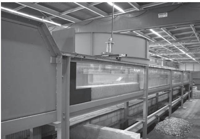
Ilustración 8b. Vista del canal hidráulico para modelación experimental.
