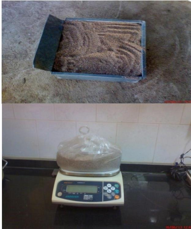
**Figura 4.** Proceso de laboratorio de curva de granulometría.
