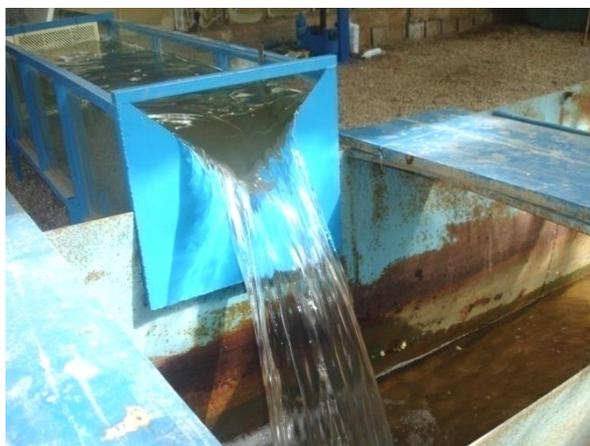
**Figura 2.** Medición de desbordamiento de  $90^\circ$  de la salida de caudal del tubo de vórtice.
