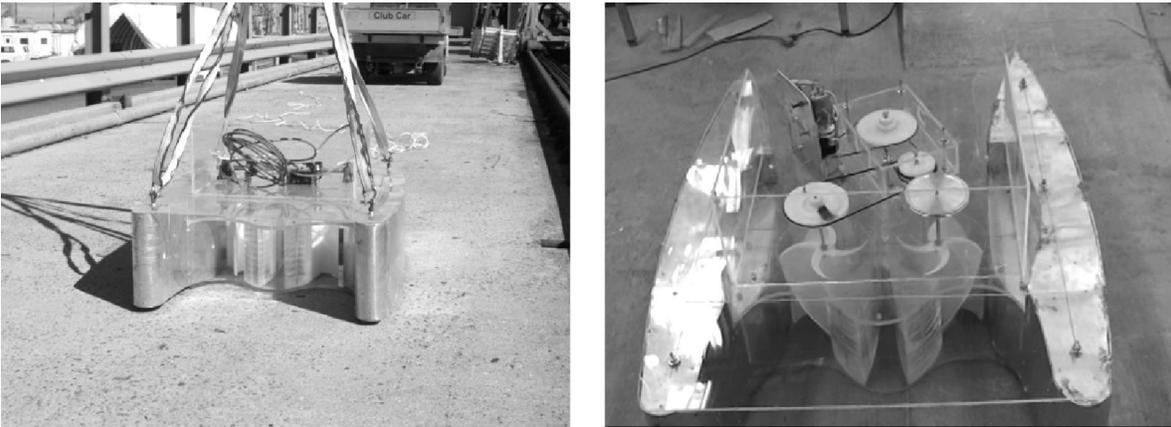
Figura 5. Hidrogenerador IMPULSA de 100 W.
