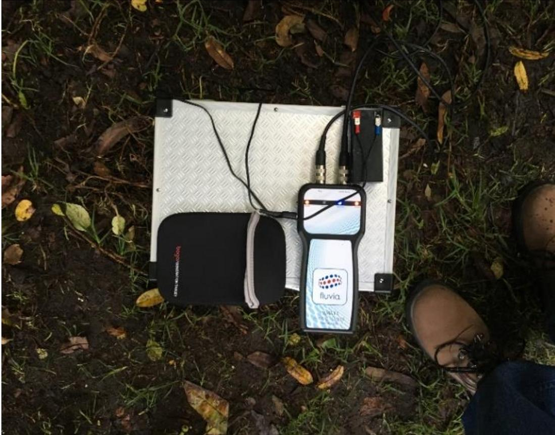
**Figura 3.** Equipo FLUVIA F-1 de medición y modelación de trazadores.
