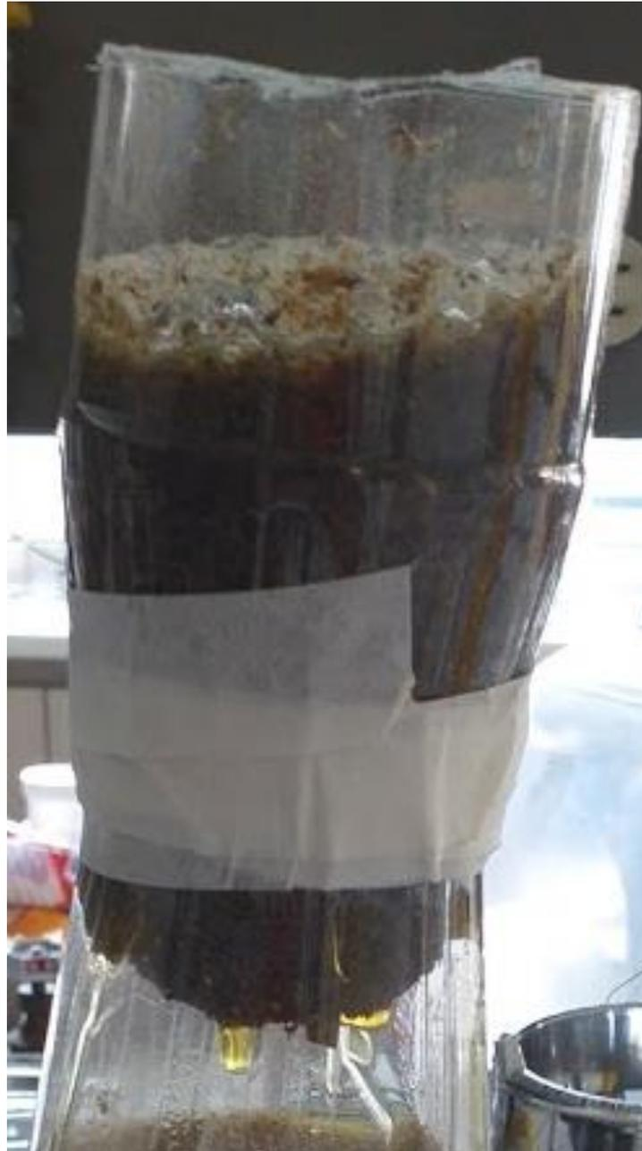
**Figura 1.** Biocolumna utilizada en el proceso de adsorción.
