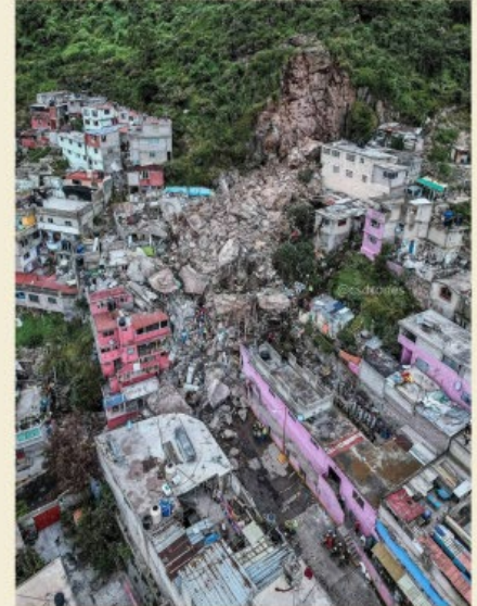
Alud de rocas después de la ocurrencia de un sismo y lluvia intensa
