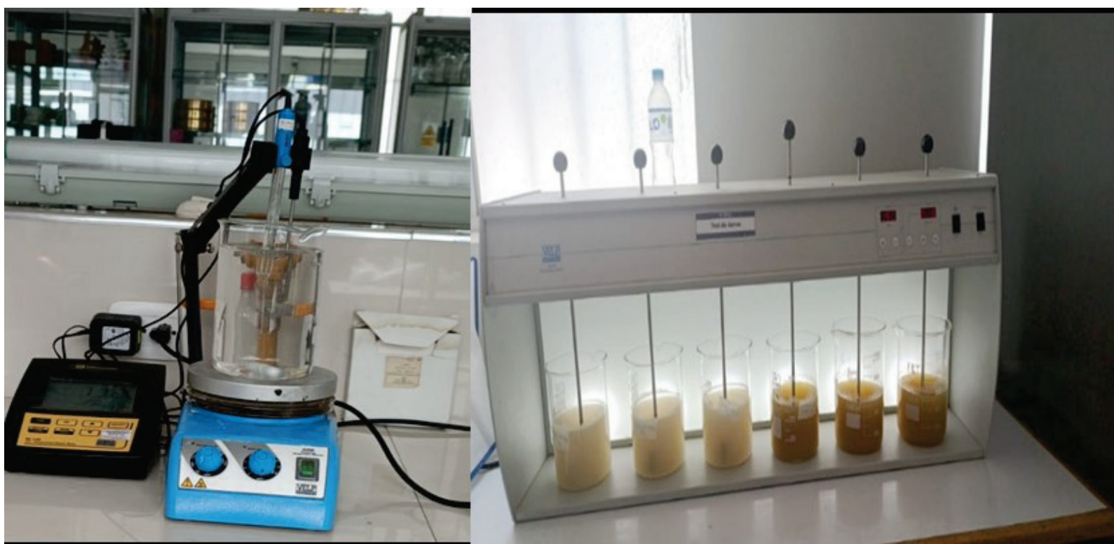
Figura 2. Ajuste del potencial de hidrógeno y ensayo de prueba de jarra.
