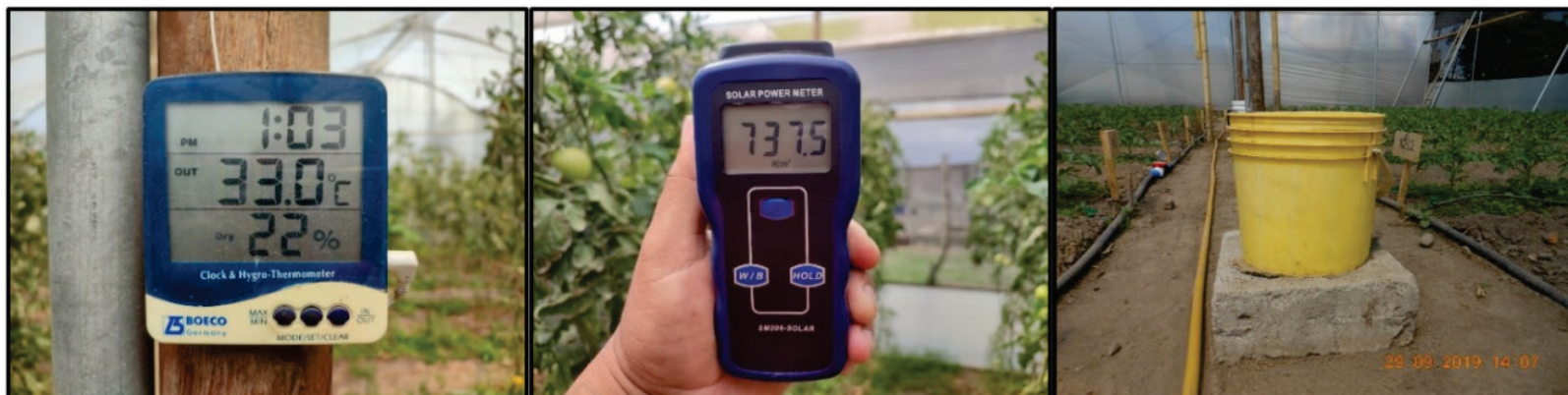
Figura 1. Dispositivos experimentales utilizados en este trabajo: (a) estación meteorológica, (b) piranómetro y (c) cubeta de evaporación calibrada (Sivisaca, 2013).
