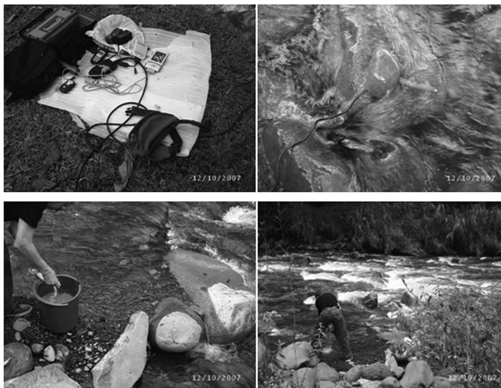
Figura 11. Aspectos del instrumento IDF y de la inyección de trazador.
