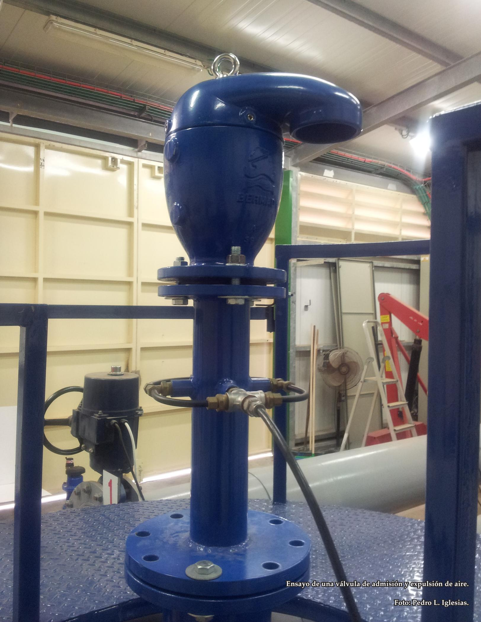
Ensayo de una válvula de admisión y expulsión de aire.
