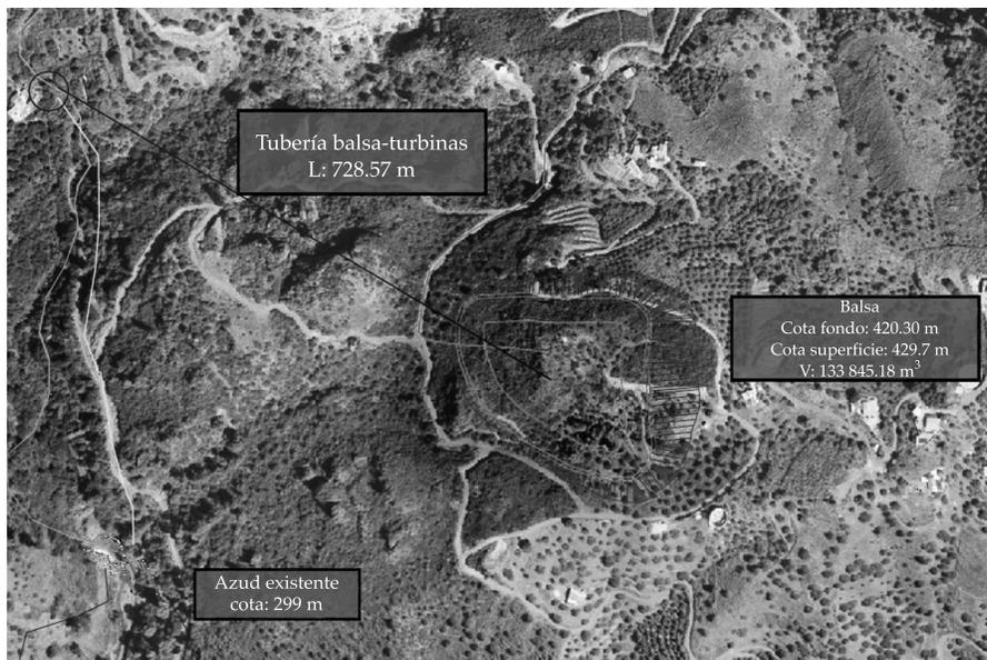
Figura 3. Diseño de nueva balsa de almacenamiento y regulación, con una capacidad de 133 845.18 m<sup>3</sup>, situada a una cota de 430 msnm.
