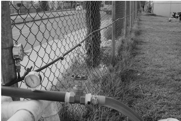
Figura 4. Control de presión en la entrada del lateral.
