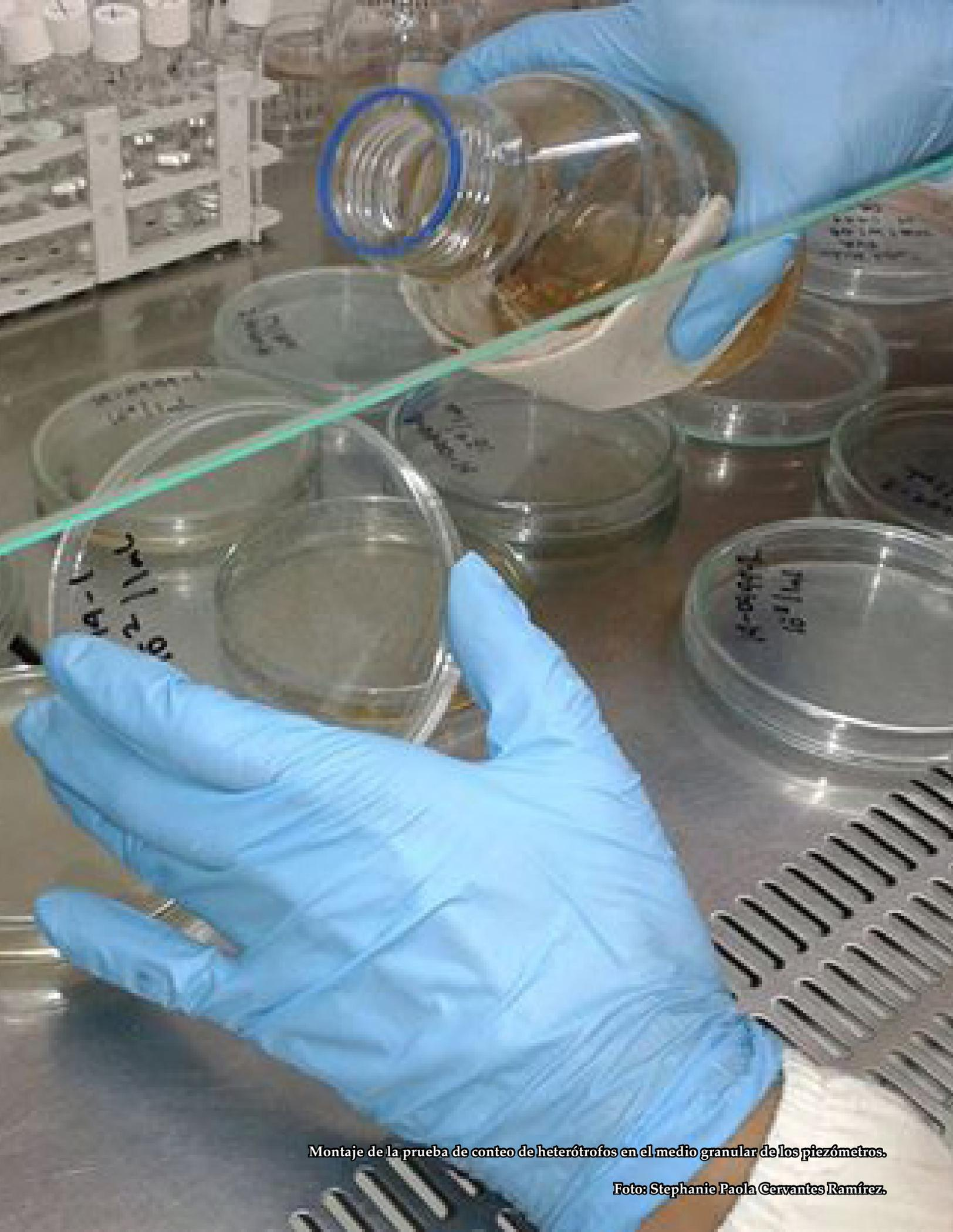
Montaje de la prueba de conteo de heterótrofos en el medio granular de los piezómetros.
