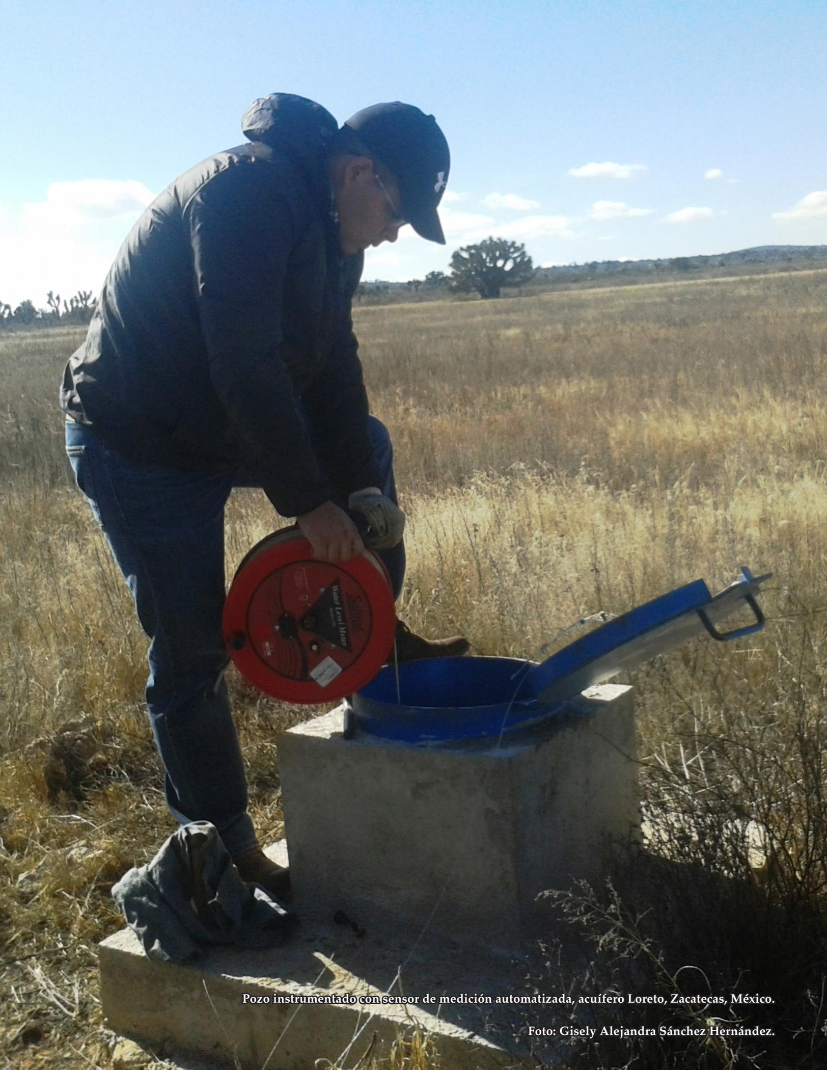
Pozo instrumentado con sensor de medición automatizada, acuífero Loreto, Zacatecas, México.
