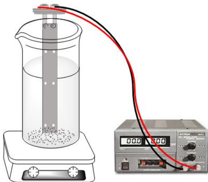
Figura 1. Celda electroquímica usada para el proceso de electro-oxidación.
