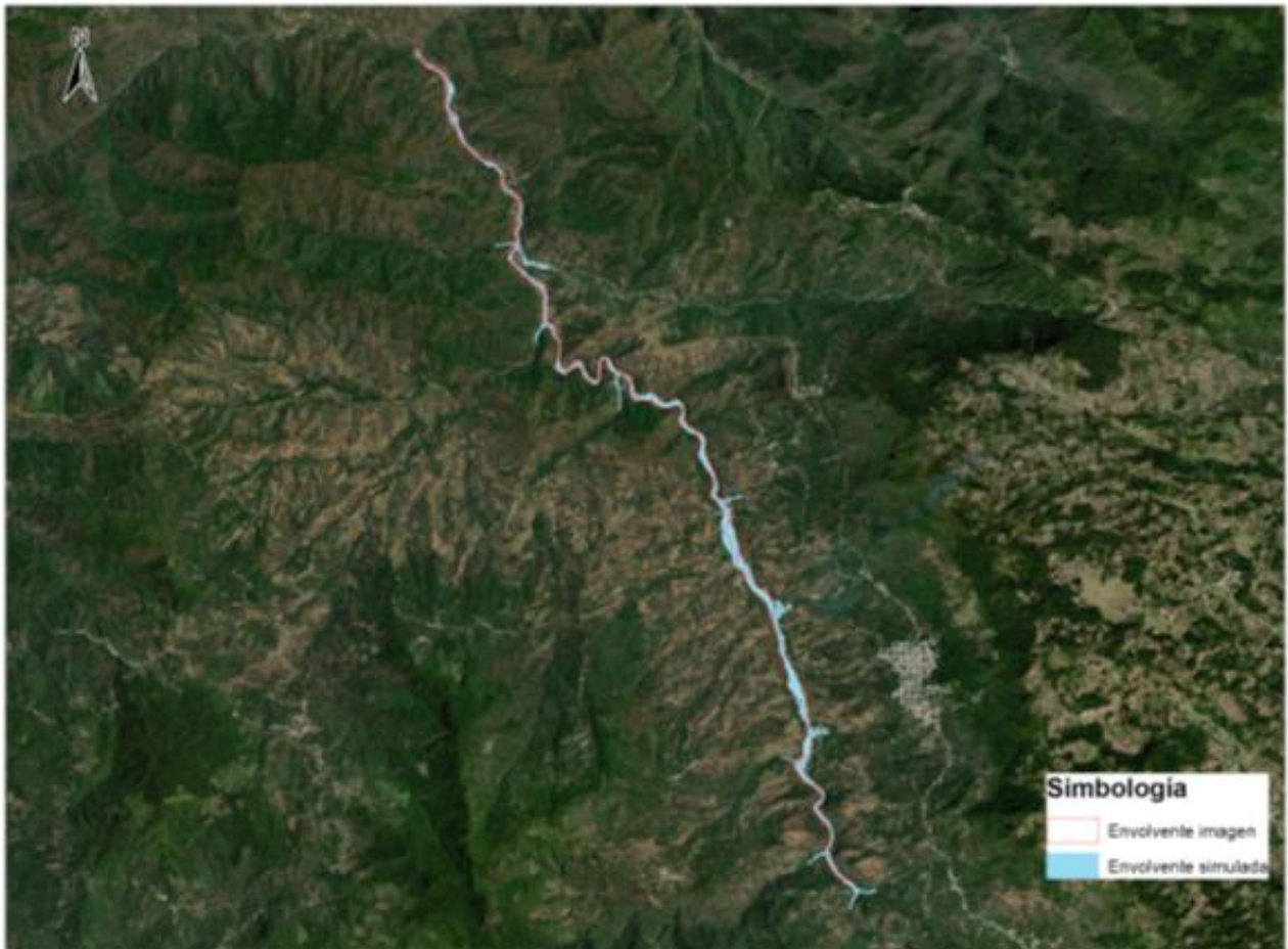
Figura 10. Envolvente visual elaborada en la imagen satelital vs. envolvente obtenida de la modelación hidráulica.
