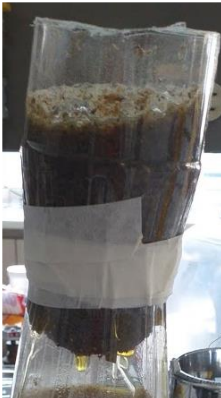
Figura 1. Biocolumna utilizada en el proceso de adsorción.
