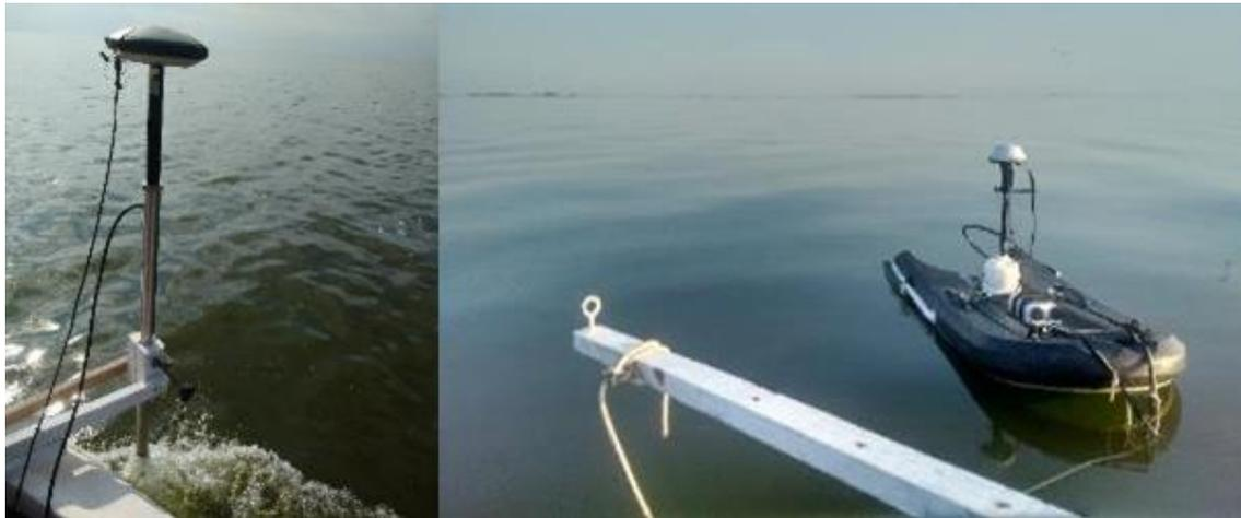
**Figura 3.** Instrumental. Izquierda: equipo GPS y ecosonda sumergida; derecha: ADCP Sontek M9.
