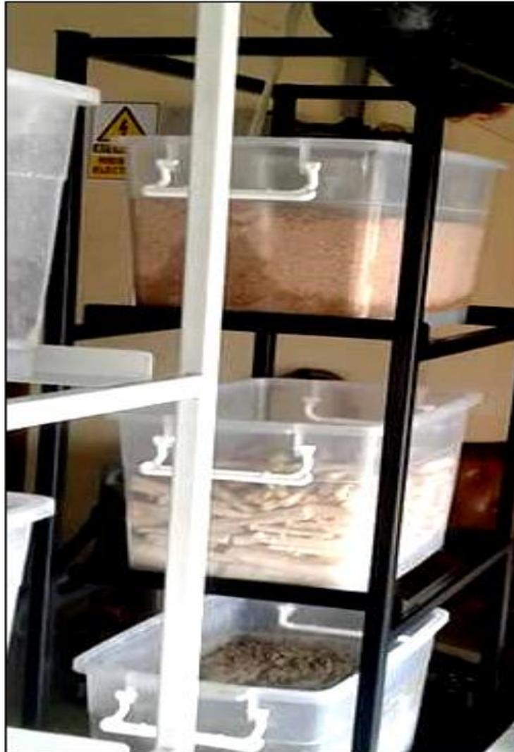
**Figura 3.** Proceso de filtración. El agua residual se vierte inicialmente desde el compartimento superior y desciende en contacto con los materiales hacia las cámaras inferiores; en la base final se recoge el líquido una vez tratado.
