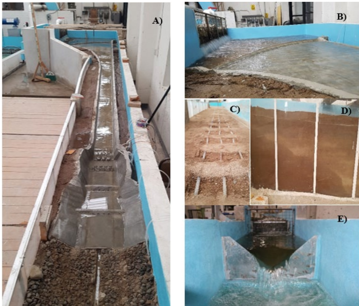
Figura 3. A) Modelo físico, vista completa de la obra de excedencias; B) pantalla reductora de velocidad, vaso, cimacio, parte inicial del canal de
