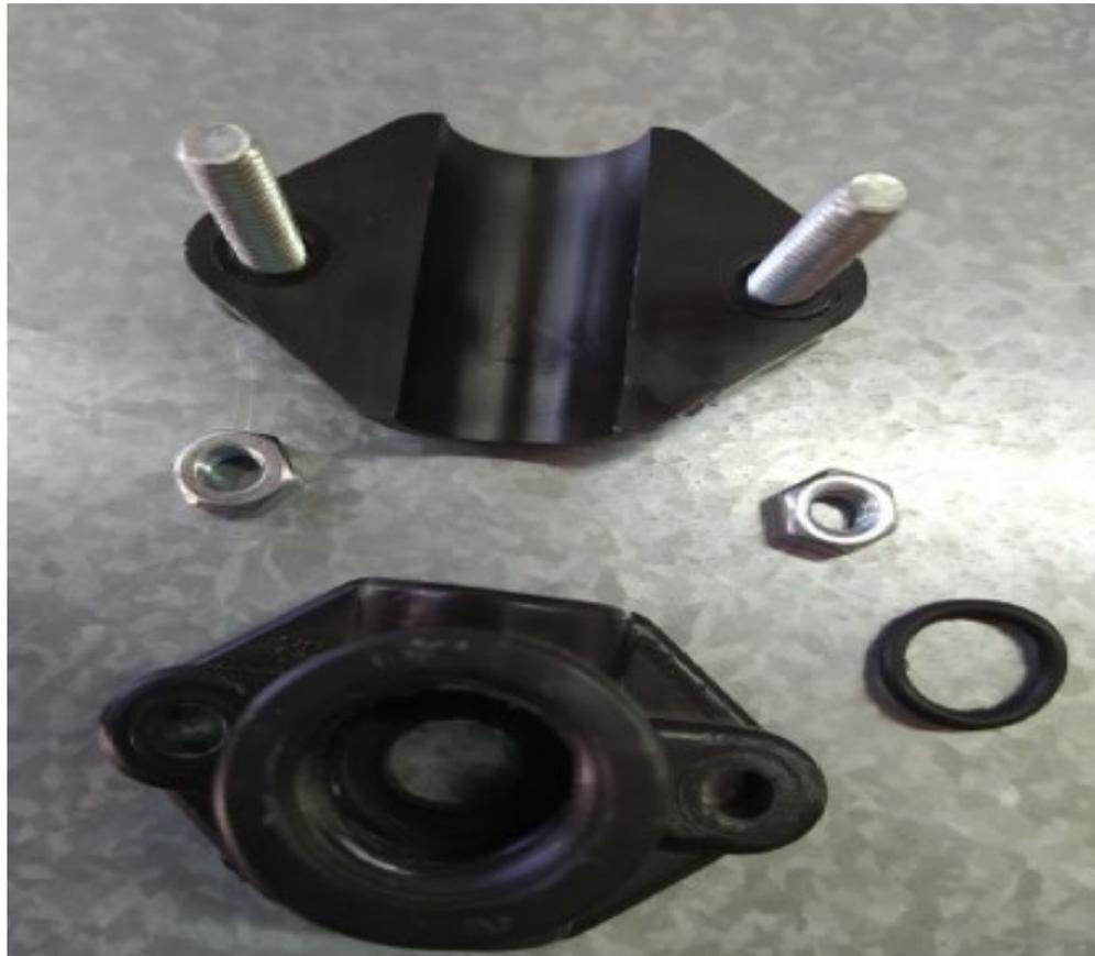
**Figura 5.** Collarín de acople de sensor a la tubería con orificio de toma de presión.
