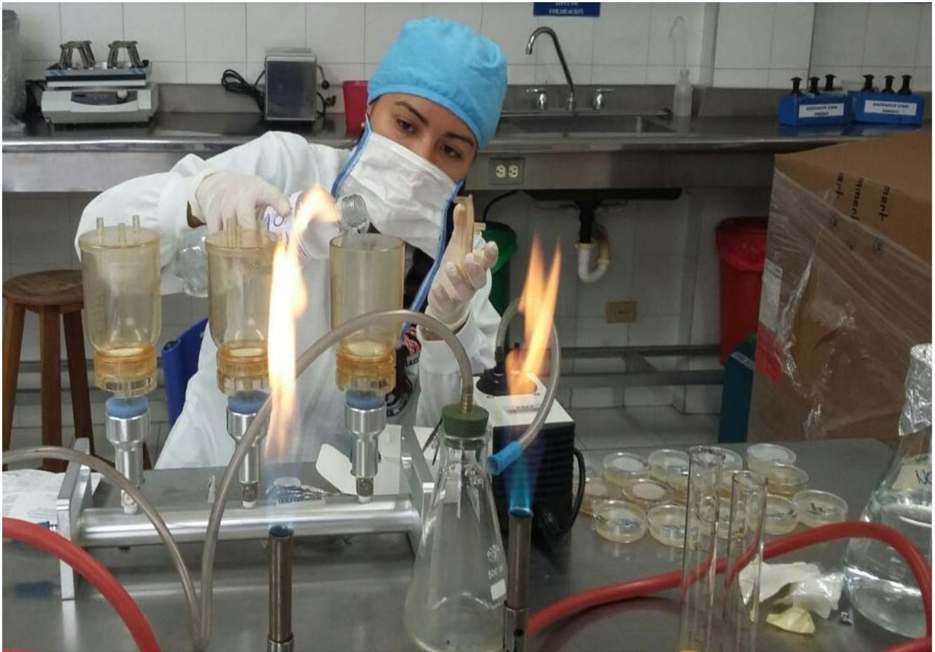
**Figura 2.** Método de filtración por membrana.
