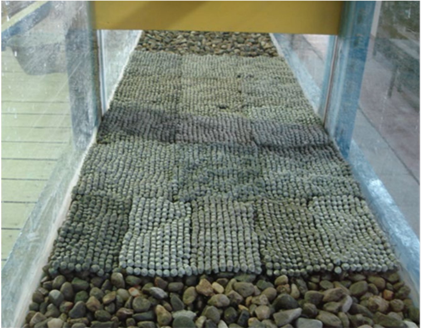
Figura 13. Tramo con mantas (capa simple con elementos de 10 mm de altura).
