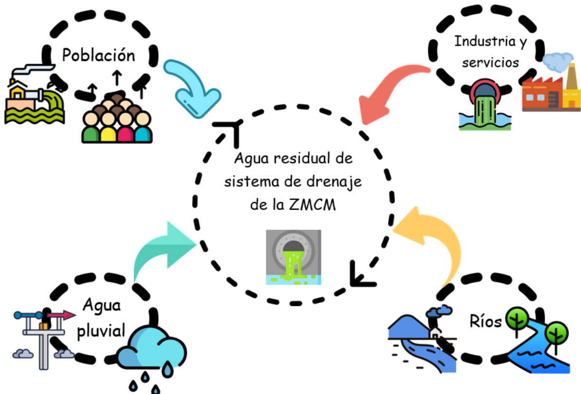
Figura 3. Esquema de las entradas de agua residual al sistema de drenaje de la Zona Metropolitana de la Ciudad de México.
