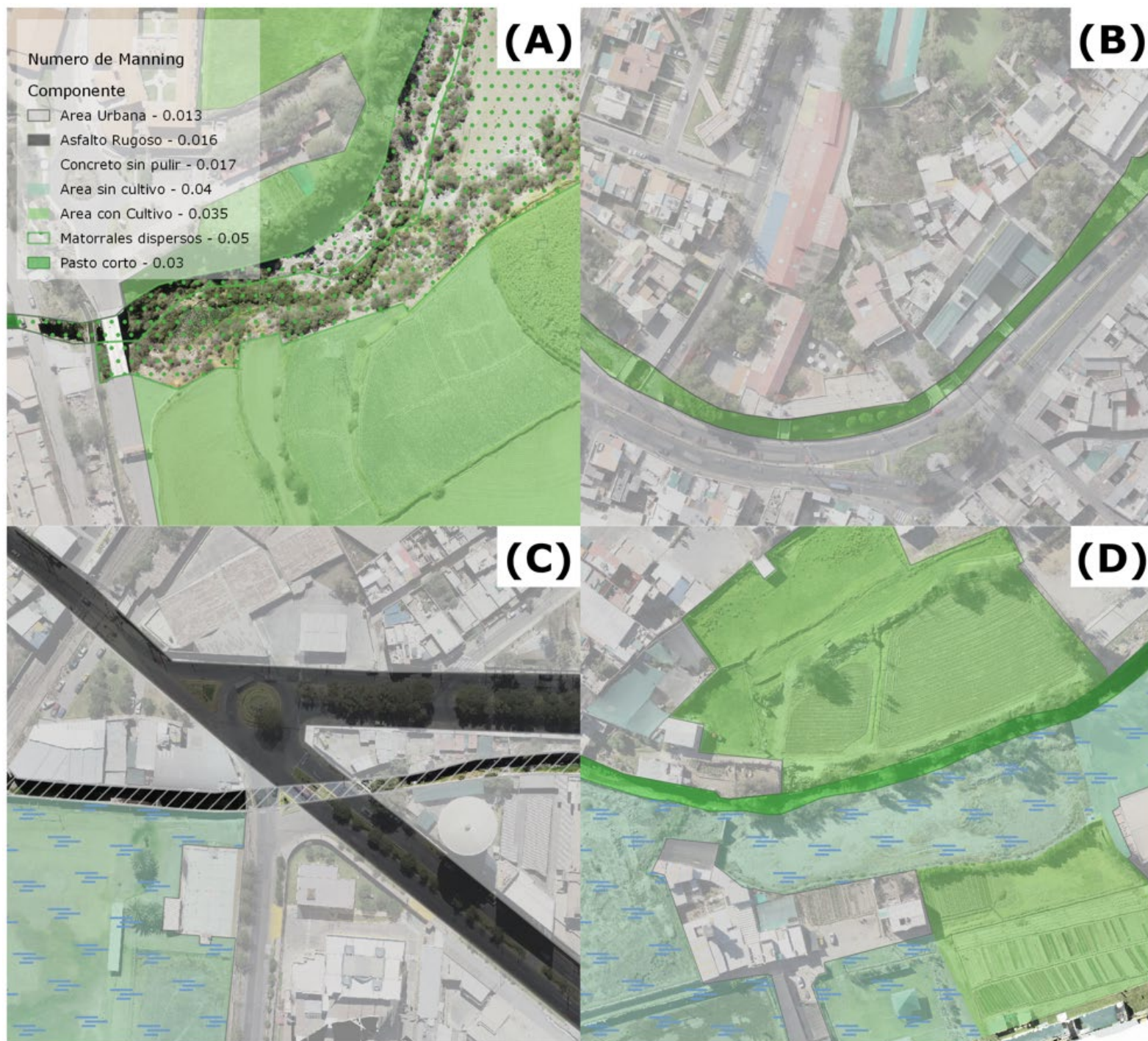
Figura 14. Coeficiente de Manning en las diferentes torrenteras de estudio: A) Del Pato, B) San Lázaro, C) Venezuela y D) Los Incas.
