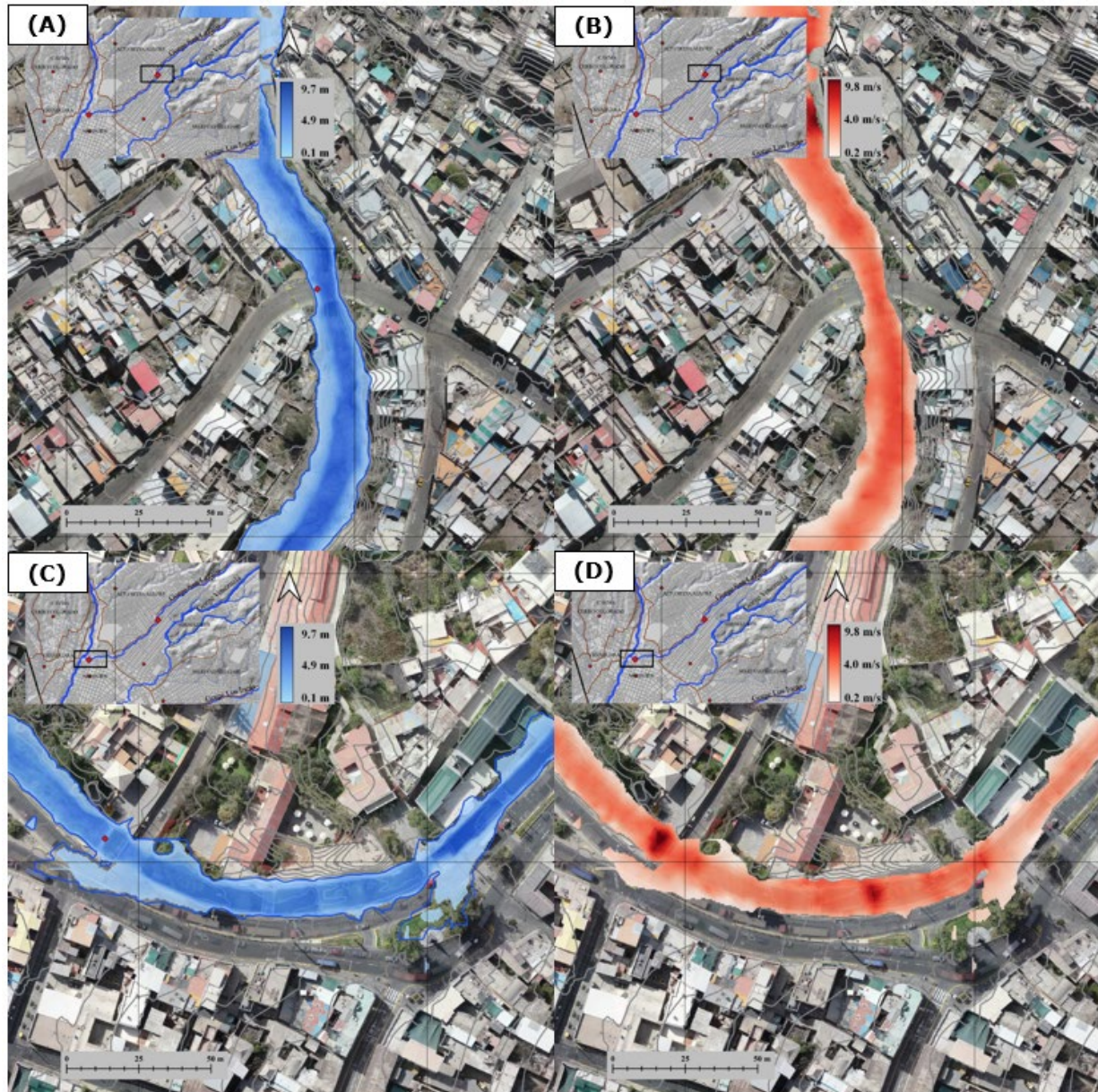
Figura 19. Mapa de peligro por inundación para un periodo de retorno de 100 años: A) y B) profundidad de agua y velocidades en el puente Cahuide; C) y D) profundidad de agua y velocidades en la Av. Juan de la Torre de la torrentera San Lázaro, utilizando el modelo numérico HEC-RAS.
