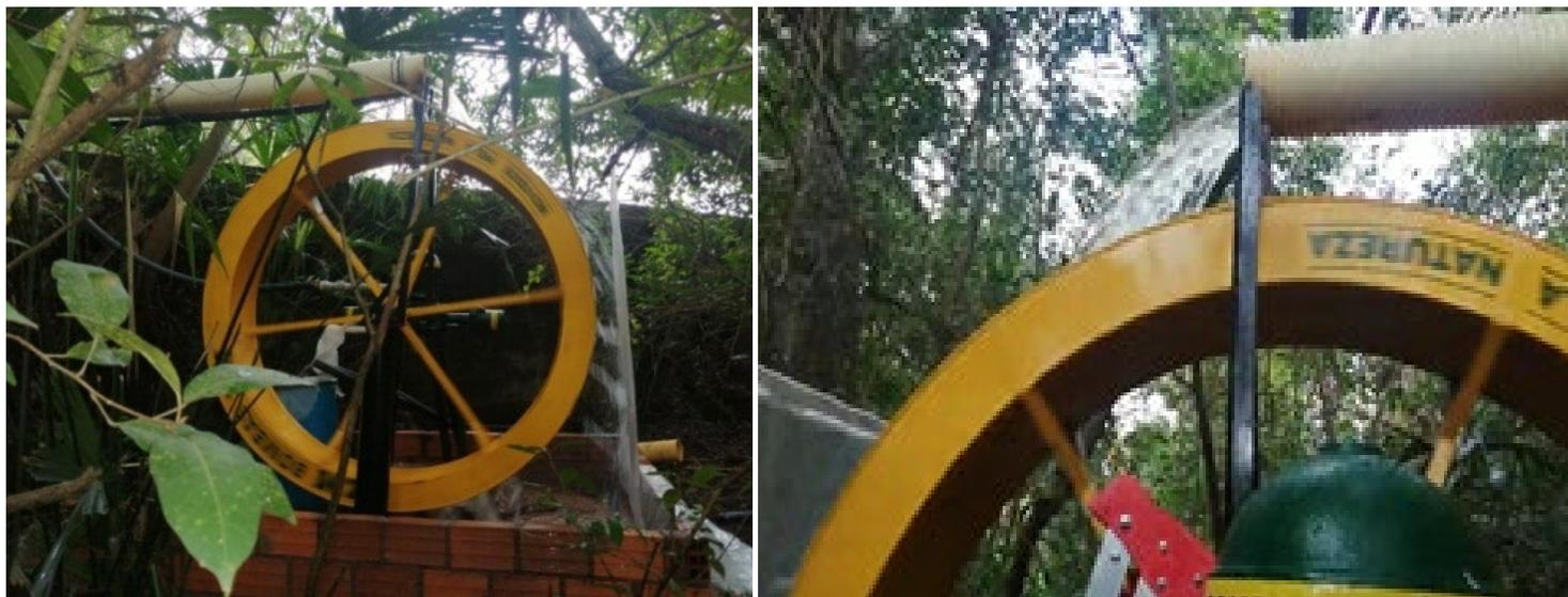
**Figura 12.** Montaje del conjunto de la Bomba ZM 95 MAXXI (izquierda); tubería de accionamiento del sistema (derecha).
