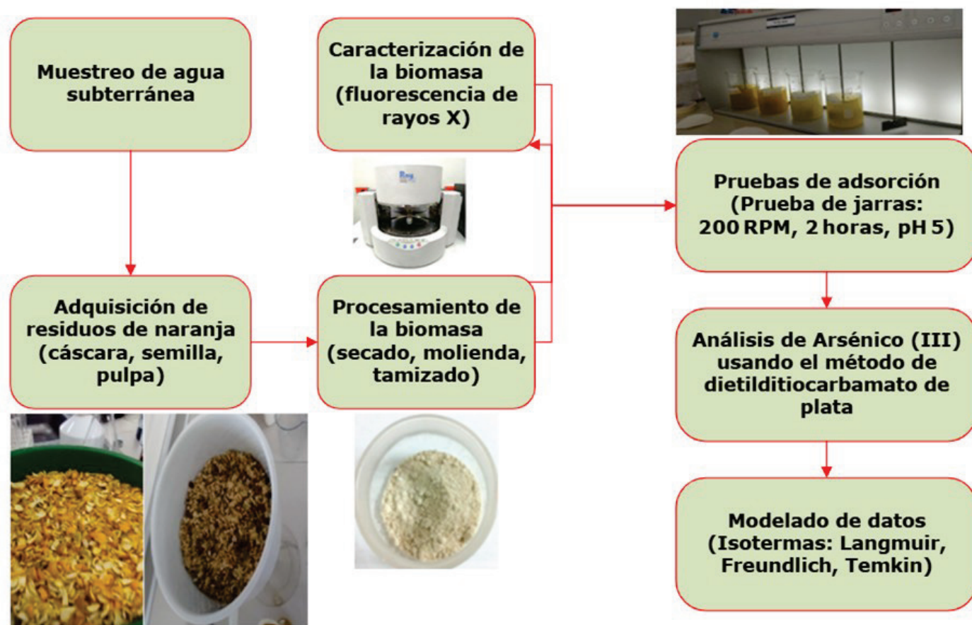
Figura 4. Diagrama de la metodología de la remoción de arsénico.
