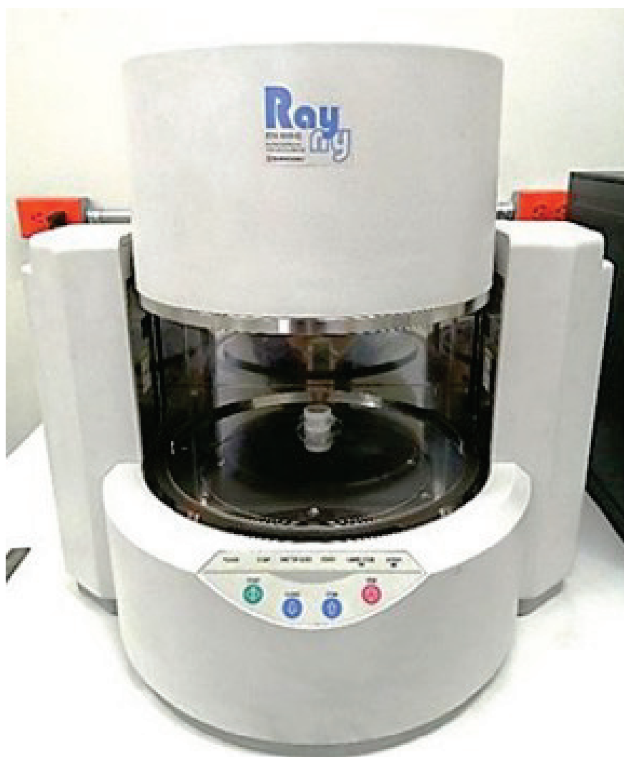
Figura 3. Espectrómetro de fluorescencia de rayos X de energía dispersa (Shimadzu-EDX-800 HS).
