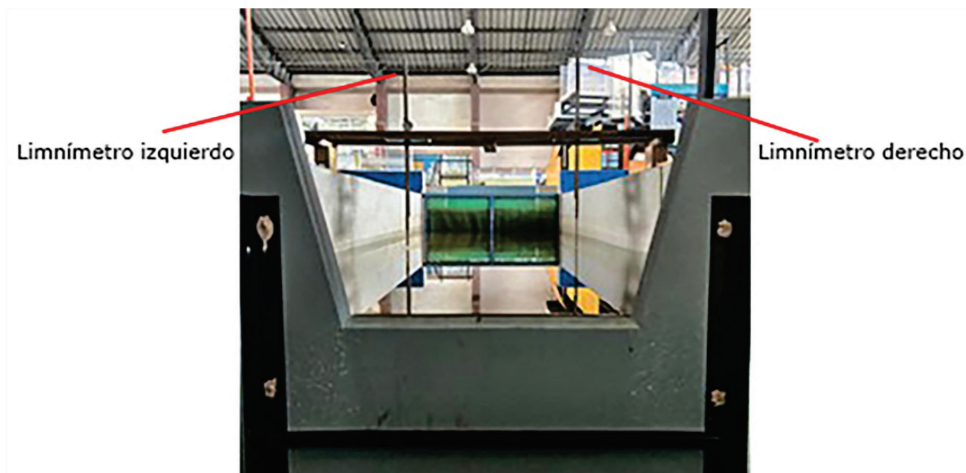
Figura 8. Estructura de control: vertedero trapezoidal.
